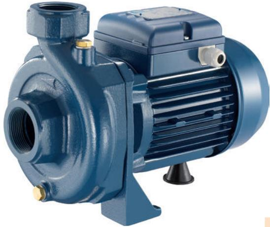
Pompe centrifughe di media portata per piccole e medie applicazioni agricole. Dotate di girante aperta per consentire il passaggio di piccoli corpi solidi ( $\varnothing$  max. 10 mm.).
